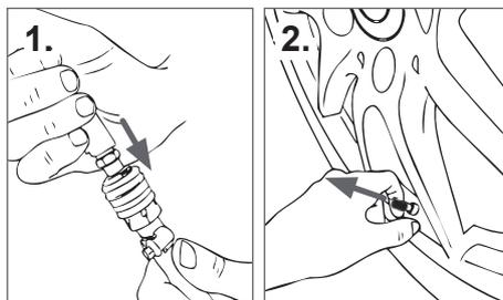
3. Schlauch an Ventil befestigen. Falls notwendig, zusätzlich (B) oder (C) dazwischen befestigen. Sicherstellen, dass keine Luft entweicht.
