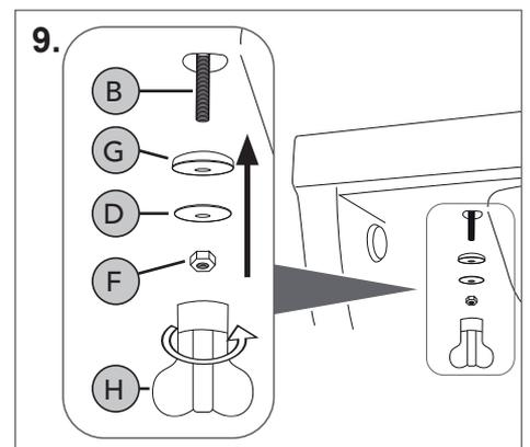
**DE** (G), (D) und (H) von unten auf (B) schieben, dann (F) auf (B) schrauben. (F) mithilfe von (I) festziehen.
