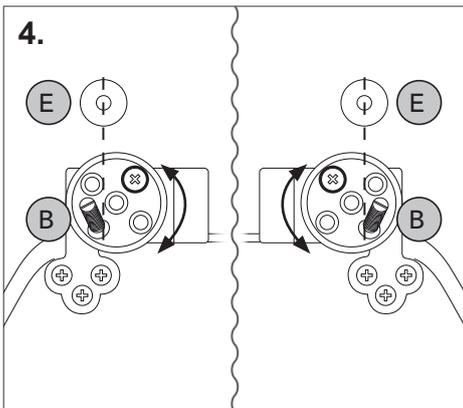
**DE** (B) und (E) müssen auf beiden Seiten in einer Linie liegen. Dafür ggf. die Scharnierschrauben lockern, dann die Scharniere ausrichten.
