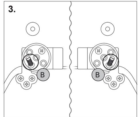
**DE** (B) in die untere Bohrung der Scharniere drehen.
