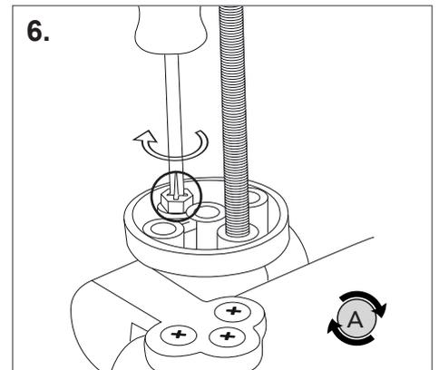
**DE** (A) mit der **Unterseite nach oben** drehen. Scharnierschrauben festdrehen.
