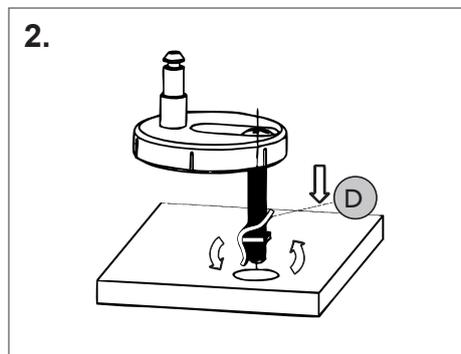
**DE** (D) anheben. (D) und (E) durch Öffnung führen.
