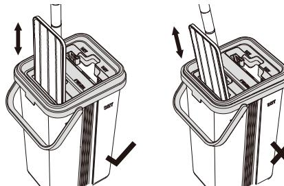
De reinigingsvoet (3) in de gleuf op het uitwring-opzetstuk (7) met het opschrift **DRY (drogen)** aanbrengen. Meerdere malen omhoog en omlaag bewegen tot de gewenste vochtigheid van de reinigingsdoek (4) werd bereikt.
