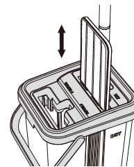
De reinigingsvoet (3) in de gleuf op het uitwring-opzetstuk (7) met het opschrift **WASH (wassen)** aanbrengen en in het water leggen. Voorzichtig er weer uittrekken.
