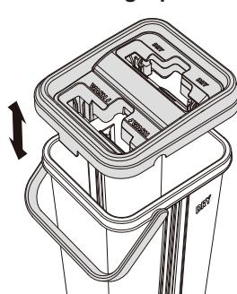
Let er daarbij op, dat het uitwring-opzetstuk (7) goed rondom wordt geplaatst. Het opzetstuk laat zich anders niet bevestigen.
