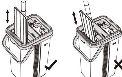
Den Reinigungsfuß (3) in den Schlitz am Auswringaufsatz (7) mit der Aufschrift **DRY** stecken. Mehrfach hoch und runter bewegen, bis die gewünschte Feuchtigkeit des Reinigungstuches (4) erreicht wurde.
