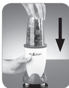
3. Stellen Sie nun den Mixbecher in die Motoreinheit (Der Klingenaufsatzt wird in der Motoreinheit „versenkt“; siehe Abbildung). Achten Sie darauf, dass die Rastnasen am Mixbecher korrekt in den Aussparungen der Motoreinheit liegen.
